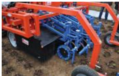
Ferrari: Remoweed, sarchiatrice automatica per le insalate in cespo.
