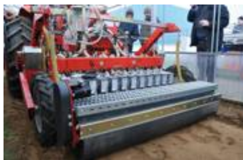
Agricola Italiana: AI-640-SN-3 pneumatica di precisione con interfila 40 mm.
