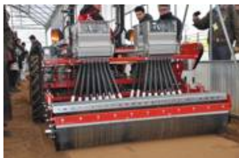
Agricola Italiana: 620 SNT meccanica con interfila 50 mm.
