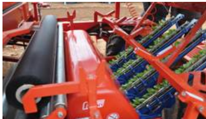
Ferrari: FPC, semiautomatica per il trapianto de cubetto su film di pacciamatura.
