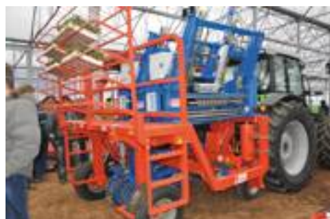
Ferrari: Remoweed, sarchiatrice automatica per le insalate in cespo.
